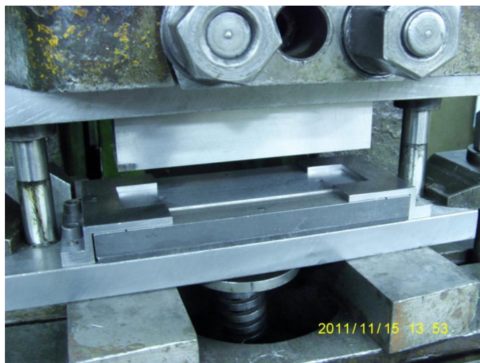
Рисунок 7 – Оснастка вырубного штампа, установленная на пресс
