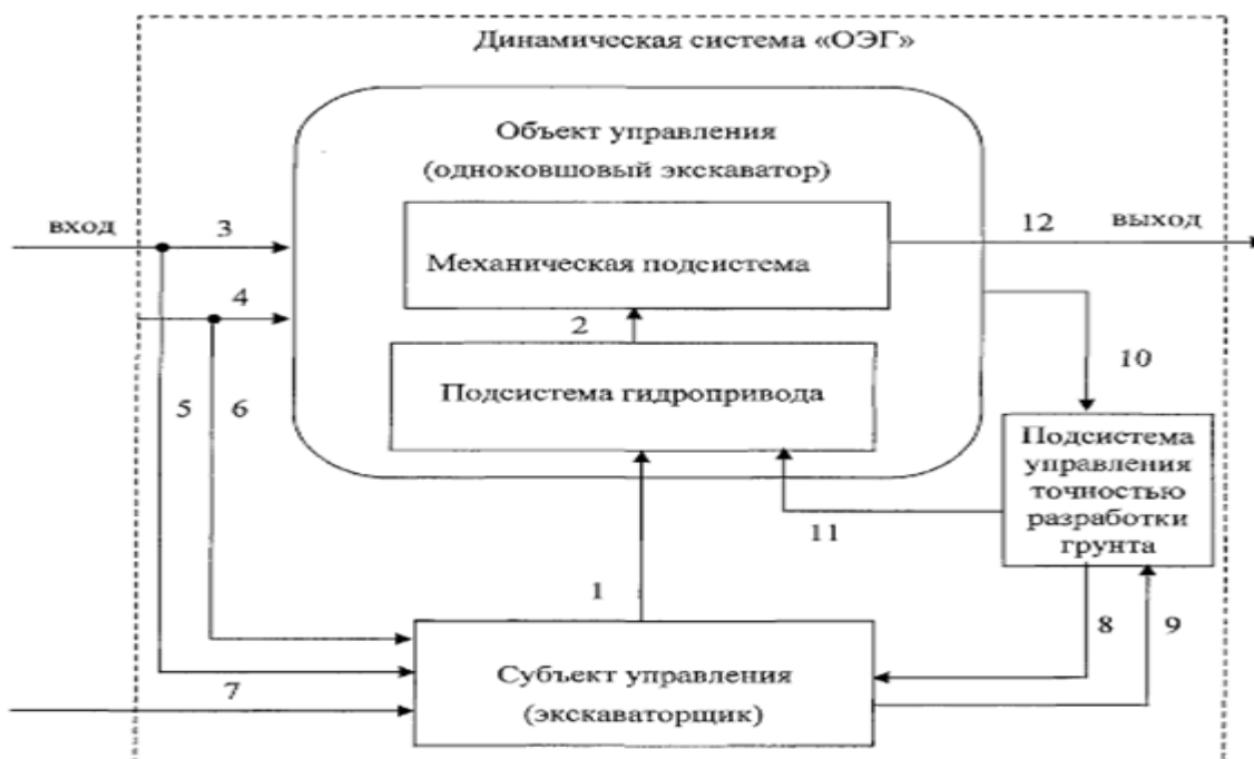
Рисунок 1 Структурная схема динамической системы одноковшового экскаватора с гидроприводом
