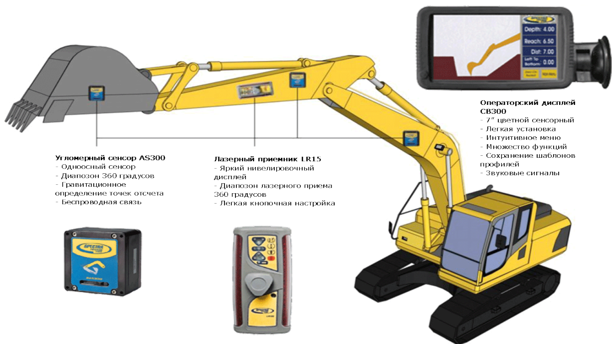
Рисунок 2 - Система управления для экскаваторов Trimble DDS300
