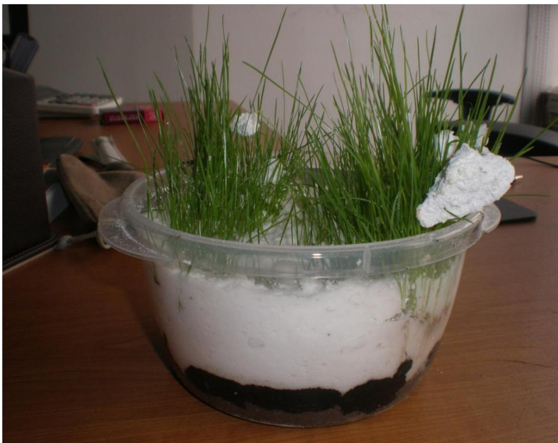
Рис.1. Результаты лабораторного выращивания травы на нефтяной линзе покрытой сорбентом «Униполимер-М»
