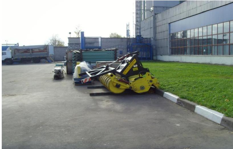
Рис.2. Общий вид опытного рабочего прицепного устройства для очистки нефтезагрязненных земель
