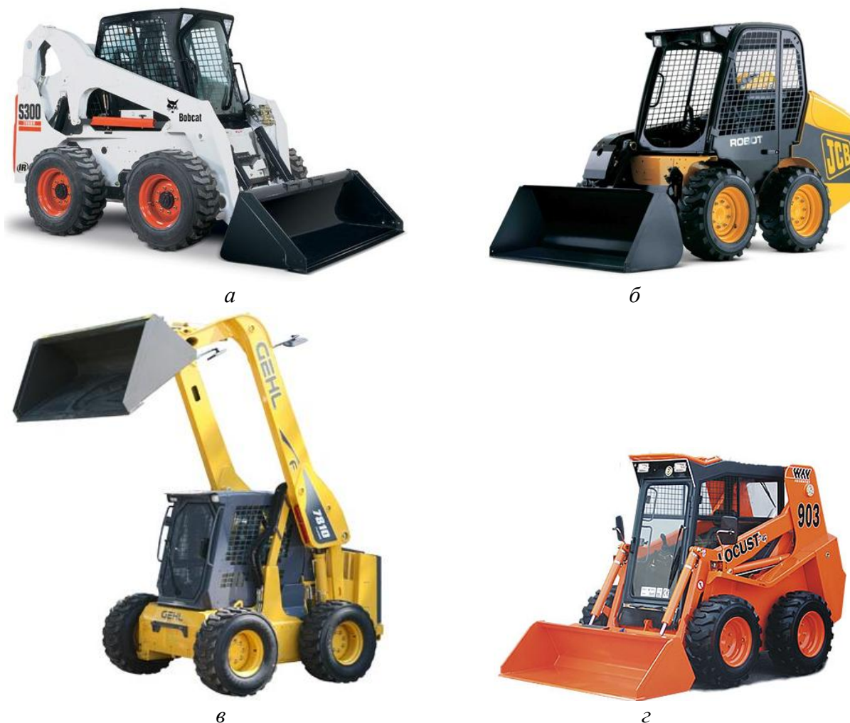
Рисунок 1 – Конструкция рабочего оборудования малогабаритных погрузчиков : а – Bobcat S300; б – Case JCB Robot; в – Gehl 7810; г – Locust L 903
