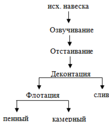
Рисунок 1 – Схема флотации свинцового концентрата
