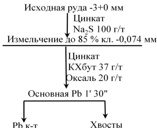
Рисунок 1 - Схема флотации галенита с депрессией сфалерита цинкатом
