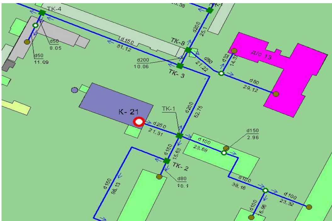
Рис. 1. Схема тепловых труб, насосных станций и замерных узлов
