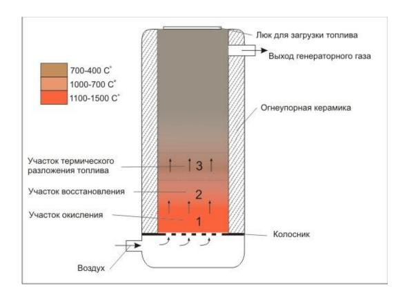
1 вариант газогенератора. Самый простой и распространенный вариант газогенератора — газификация в плотном слое, воздушное дутье и жидкошлачное удаление шлаковых образований.
