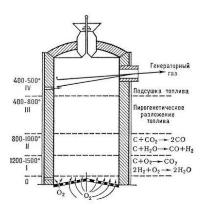
Рис. 1. Схема прямого процесса образования газа в газогенераторе.
