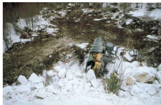
Рисунок 2 - Следы разрушения породного вала и положение автосамосвала под откосом
