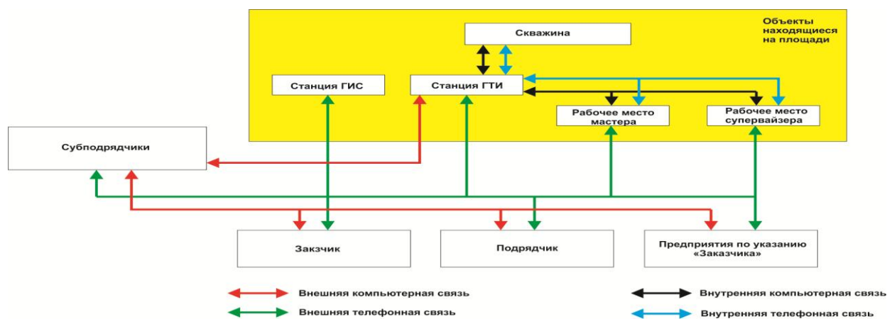
Рис.12. Схема связи на скважине с удаленными объектами.
