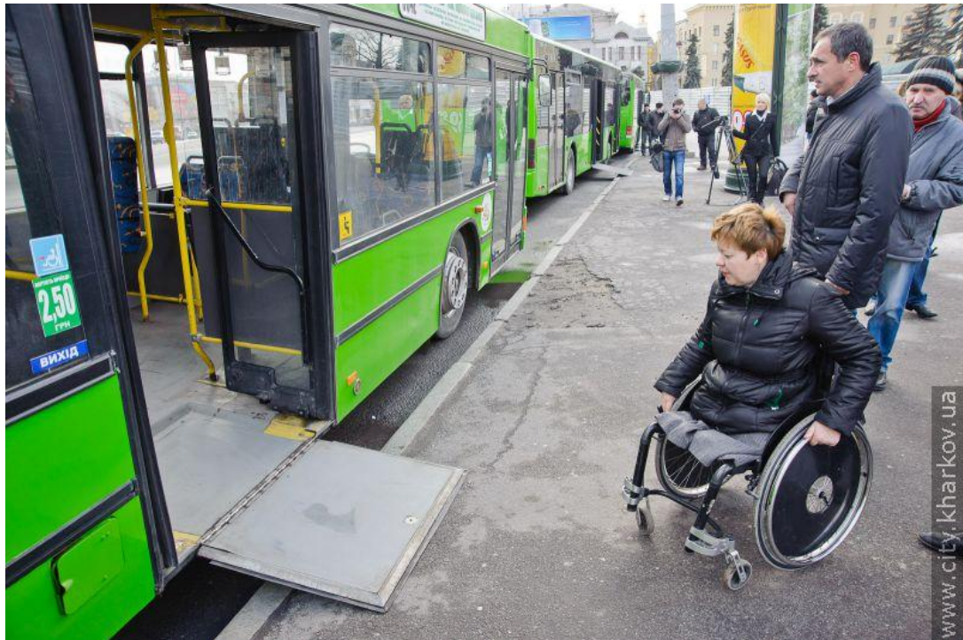
Рисунок 2 -Автобус «МАЗ» со специальным пандусом
