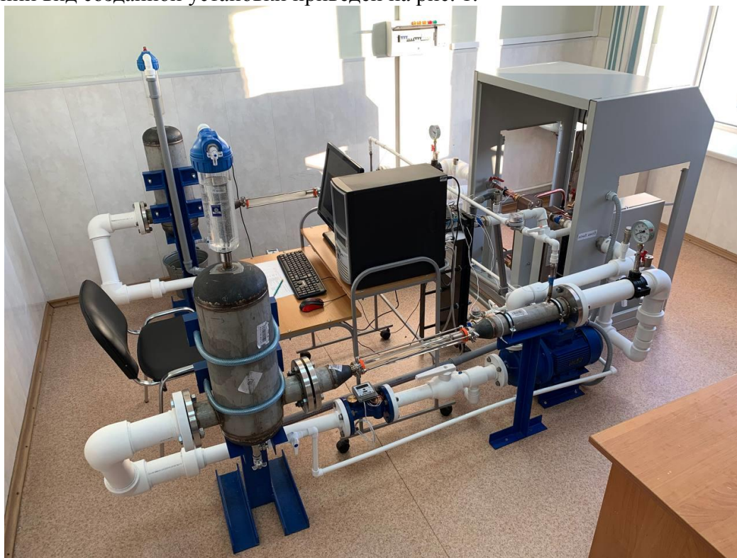
Рис. 1. Внешний вид кавитационной опреснительной установки
