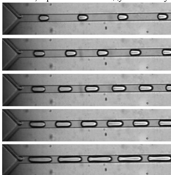
Рис. 1. Снарядный режим течения при фиксированном расходе нефти Q_o=1,7 \times 10^{-11} \text{ м}^3/\text{с} и варьируемом расходе воды (сверху вниз) Q_w=8,3 \times 10^{-12} \text{ м}^3/\text{с} ; Q_w=1 \times 10^{-11} \text{ м}^3/\text{с} ; Q_w=1,3 \times 10^{-11} \text{ м}^3/\text{с} ; Q_w=1,7 \times 10^{-11} \text{ м}^3/\text{с} ; Q_w=3,3 \times 10^{-11} \text{ м}^3/\text{с} .
