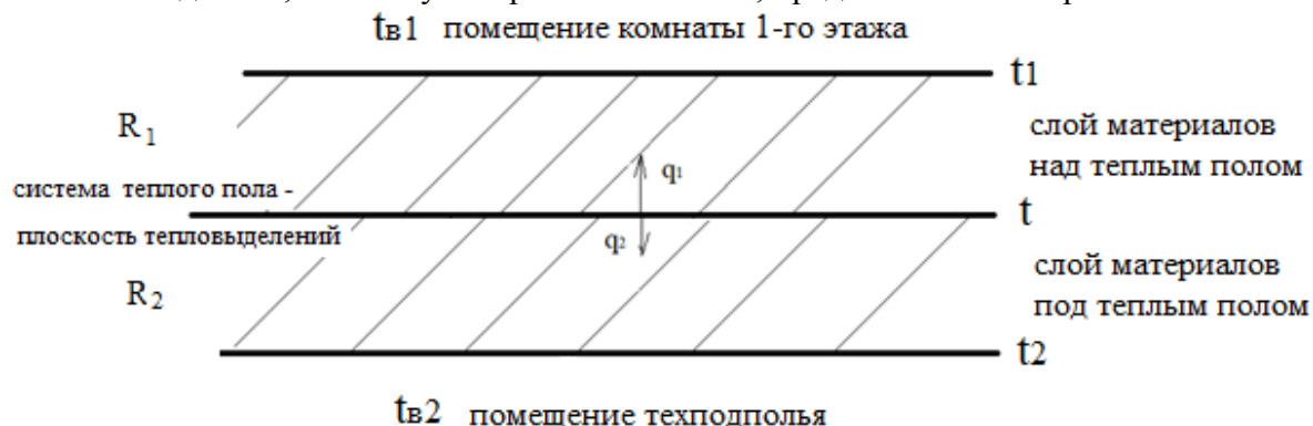
Рис. 1. Расчетная схема перекрытия над техподпольем с системой теплого пола В соответствии с представленной расчётной схемой рассмотрена система уравнений:
