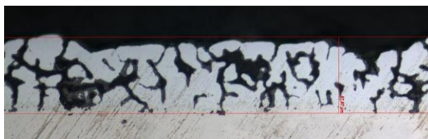
Рис .1. Профили среза образца из нержавеющей стали с хромовым покрытием после экспериментов
